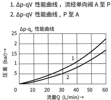
该性能曲线在整个流程范围内对出口压力 =0 有效
